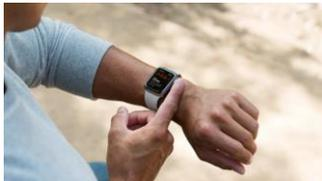
Startet der Nutzer die EKG-App, wird er aufgefordert den Finger auf die Krone zu legen und den Arm, der die Watch trägt, ruhig zu halten. Nach rund 30 Sekunden sind 3 Ergebnisse möglich:
