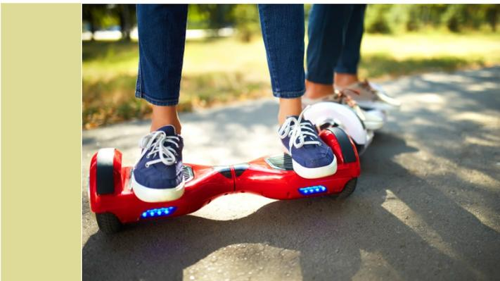
Ein Hoverboard ist eine Art Mini-Segway, denn auch hierbei handelt es sich um ein elektrisch angetriebenes Ein-Personen-Transportmittel – jedoch ohne Lenkstange. Wie beim großen und sehr teuren Segway fährt, bremst und lenkt der Fahrer das Hoverboard durch Gewichtsverlagerung. Hoverboards erreichen Geschwindigkeiten von bis zu 20 km/h. Trotzdem betrach-
