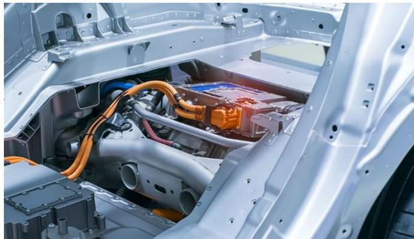
Die HV-Batterie wird vermehrt auch **als stabilisierendes Bauteil im Chassis** genutzt und mit einem speziellen Unterbodenschutz versehen, was sie für Löscharbeiten tlw. sehr schwer erreichbar macht. Am ehesten wird die HV-Batterie baubedingt bei Zusammenstößen an der Fahrzeugseite geschädigt.
